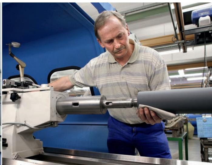
Im Labor für Forschung und Entwicklung bei Westland: Achim Siebert (Weros Technology GmbH, links) mit einem Techniker, demonstriert die verschiedenen Oberflächen von Walzenwerkstoffen auf Fluorkautschuk (FKM)- und Nitrilbutadienkautschuk (NBR)-Basis. Rechts: Der letzte Schliff: Eine homogene gleichmäßige Oberfläche ist auch bei Walzen sehr wichtig.
